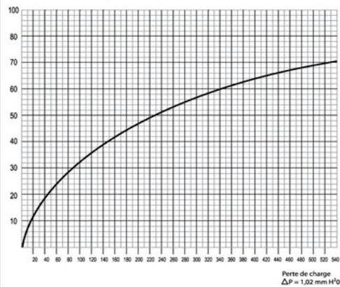
Variation de la contrepression en fonction de la température des gaz d'échappement
